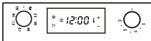
Переключатель режимов и ручку терморегулятора перевести в положении «0». Символы «» и «» погаснут, освещение электрошкафа выключится. Приготовление завершено.
