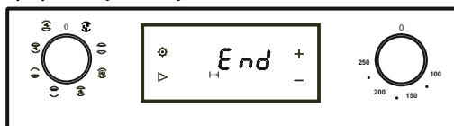
Для выключения сигнала использовать кнопки «+» или «-». Нажать кнопку «». Индикация «END» и символ «» погаснут, на дисплее отразиться текущее время, загорятся символы «» и «», включится освещение электрошкафа.
