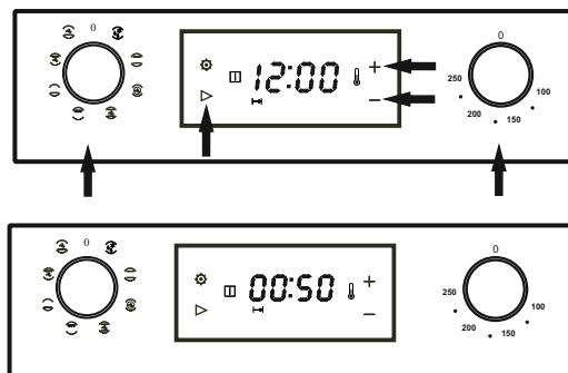
По истечении заданного времени гаснет индикация символов «» и «», освещение электрошкафа, на дисплее загорается индикация «END», мигает символ «» и звучит звуковой сигнал.
